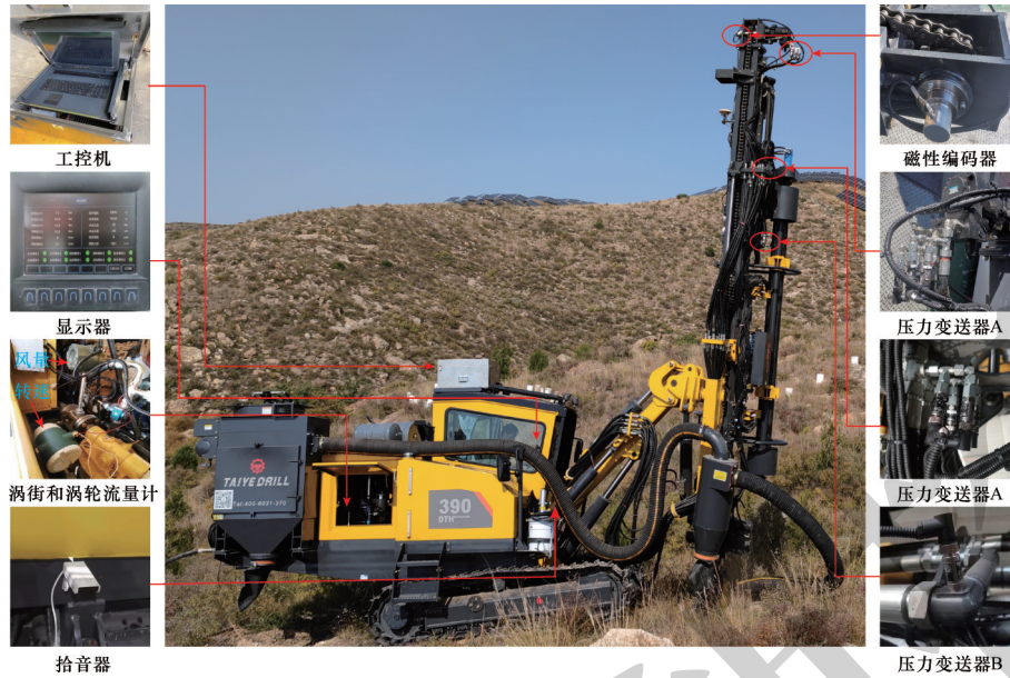
图1 潜孔钻机随钻测量系统
