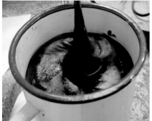
图 4 SM 植物胶冲洗液爬杆现象实物图
