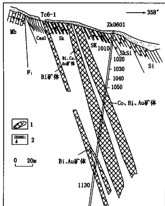
图2 肯德可克矿床6勘探线剖面图
