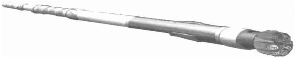
图 1 自动控向钻具结构示意图
