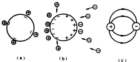
图1 偶极形成的电动力学模型
