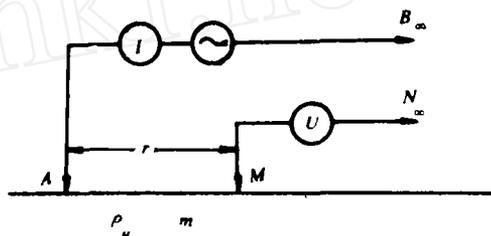
图2 求M点电位的装置
