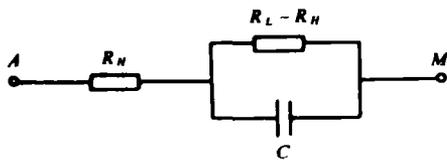
图 4 电动力学模型的等效电路图
