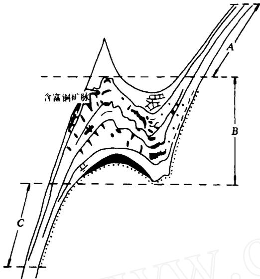
图3 赞比亚铜矿中央竖井北部Nkana主拖曳褶皱部位矿石品位加富示意图
