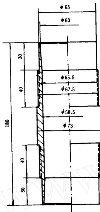
险断面壁厚由2毫米增加到3.5毫米;另外,接手两端各加长30毫米,加长部分的外径略小于套管内径,与套管连接后可加强丝扣根部的抗弯强度。
