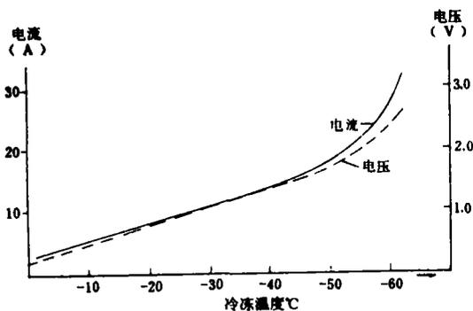
图6 供电电流、电压和冷冻温度的关系
