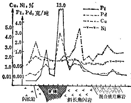
图4 K39探槽铂、钯、镍、钴品位曲线图件, 矿化可能与中低温热液活动有关等等。
