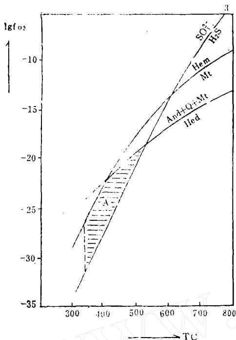
图9 钙铁辉石、磁铁矿及硬石膏共生图
