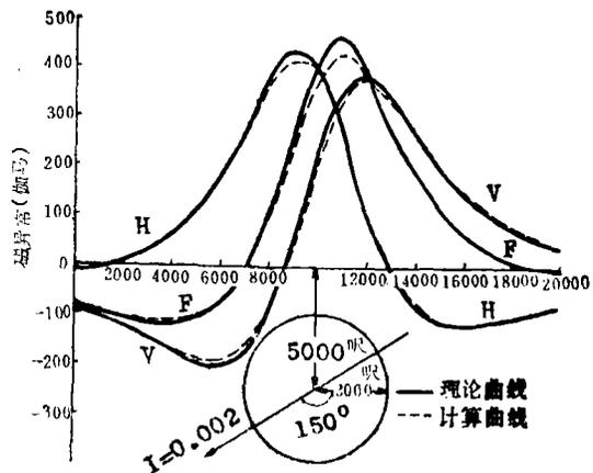
图3 东西走向、磁化倾角为 $50^\circ$ 的水平圆柱体上方理论的与计算的异常曲线
