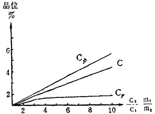
图3 厚度与品位有负相关关系时矿块的平均品位曲线
