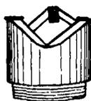
使用这种鑽头鑽进粘性頁岩与軟質粘土层，比同徑合金鑽头可提高效率 40%，因其克取面积大，能起扩大井壁作用，使之在軟質粘性岩层中鑽进不易堵塞。
