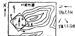
2. 再把在野外所量 X 点的岩层产状在地形图 X 点的位置上慢慢的移动（移动时罗盘一边不离开 X 点）。一直移动至磁针所指的方向限在野外所量 X 点的岩层产状方向一致时，就把罗盘停止不动。
